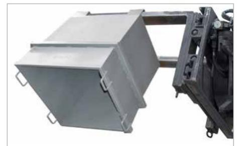
UC-Entleerung mit Stapler-Drehgerät
