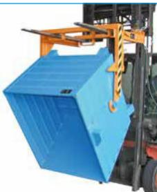
Diese Behälter haben keinen integrierten Kippmechanismus und sind somit eine preiswerte Alternative. Unabhängig von der eingesetzten Behälterstückzahl ist bei identischer Breite der Behälter nur eine Entleertraverse für den Kippvorgang erforderlich. Für die Behälter ohne Aufnahmezapfen wird ein vorhandenes Drehgerät am Gabelstapler sowie durchgehende Einfahrtaschen am Behälter zur Entleerung vorausgesetzt.
