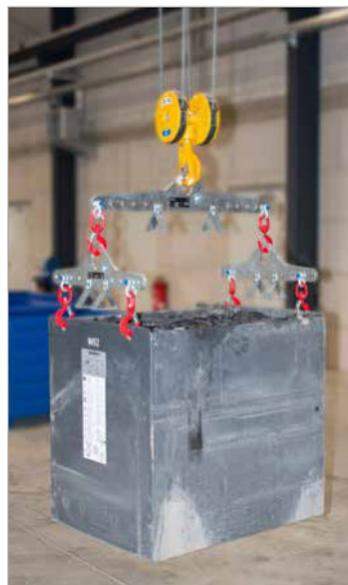
**Schneller und pendelfreier Transport von Lastgütern, Werkstücken oder Maschinenteilen per Kran.**
