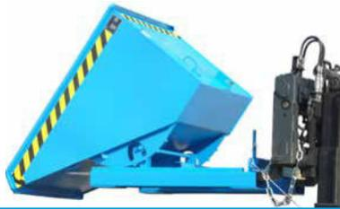
Kippbehälter mit Abrollmechanismus für staplerschonende Entleerung sowie automatisches Zurückschwenken der Behältermulde in die Ausgangsposition. Durch den günstigen Lastschwerpunkt ist eine volle Ausnutzung der Staplertragfähigkeit möglich und wird mittels Zugseilentriegelung auch in großer Höhe entleert.
