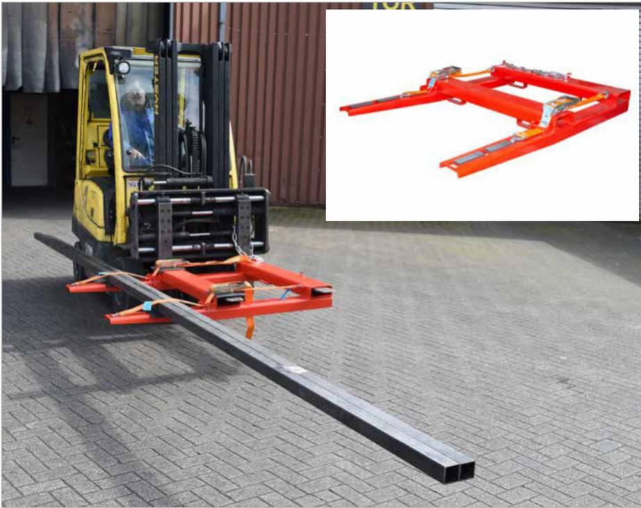
Aufnahmeposition zum Transport z.B. durch Tore oder Gänge
