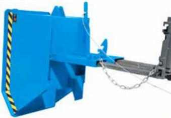
Die kompakte Bauform und geringe Bauhöhe bietet ein optimales Füllvolumen und gewährleistet durch den idealen Kippwinkel immer eine vollständige Entleerung. Der Kippvorgang erfolgt schnell und wird mittels Zugseilentriegelung ausgelöst. Ebenso ist es möglich, die Behältermulde vor dem Entriegeln auf den Behälterrand aufzusetzen und langsam durch Hochfahren des Hubmastes zu entleeren.
