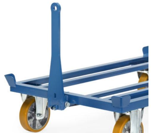
Stabiler Kupplungsbolzen  $\varnothing$  25 mm mit Führungsmaul und selbsttätiger Sicherheitsverriegelung an der Lenkrollenseite. Kupplungshöhe 205 mm.
