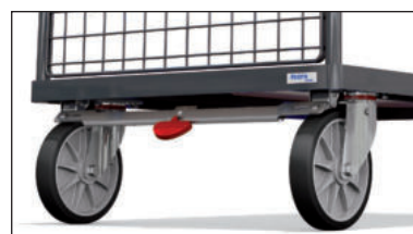
TOTALSTOP - Das fetra-Zentralbremssystem Mit nur einem Fußtritt werden Raddrehung und Schwenkbewegung beider Lenkrollen blockiert. Das Bremspedal bleibt immer im Sichtfeld des Bedieners. Serienmäßig an allen Kastenwagen.
