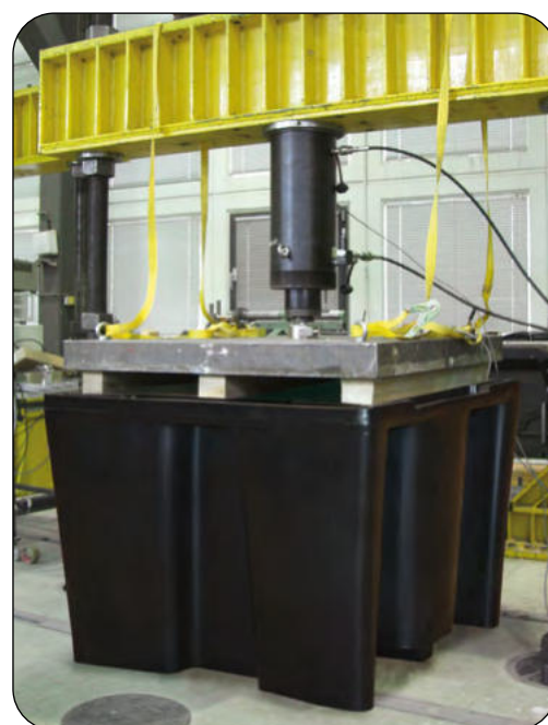
Auffangwanne PE-KT-1 unter einer Prüflast von 8.000 kg
