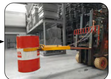
FG 2216/1, RAL 2004 - reinorange, Artikel-Nr. B69-6356-A, L x B x H in mm: 1285 x 710 x 150, Tragkraft: 400 kg
