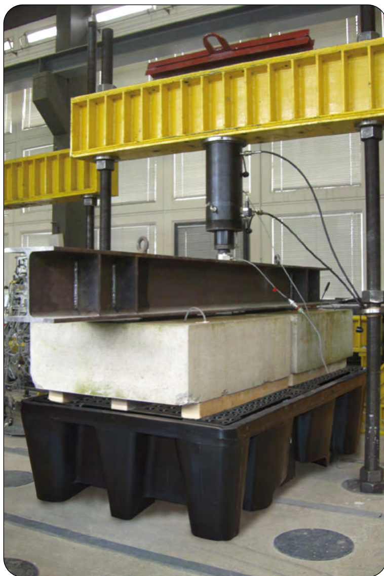
Auffangwanne PE-KT-2 unter einer Prüflast von 16.000 kg
