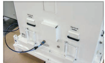
Wasserdampfdichter Behälter bei Dichtheitsprüfung durch Überdruck
