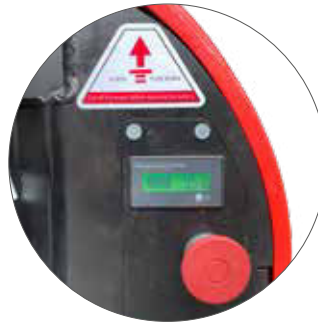
Batterieladestand- und Betriebsstundenanzeige mit Not-Aus-Knopf
