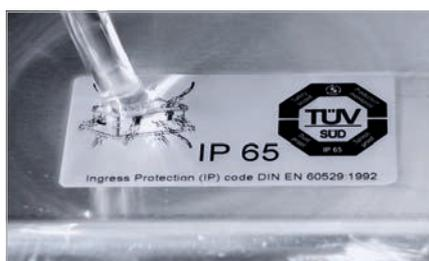
Strahlwasserschutz nach Norm IP 65
