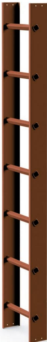
Sicherer Aufstieg auf verschiedenen Dachneigungen durch hochstabile, stationäre Leiter mit außermittiger Sprossenordnung. Trittsichere Vierkantsprossen mit 2 unterschiedlich geneigten Trittsflächen. Stabile Holmprofile für 80 mm Sicherheitsabstand der Sprossen zur Dachoberfläche. Problemlose Abstimmung der Leiter auf die jeweilige Dachlänge.
