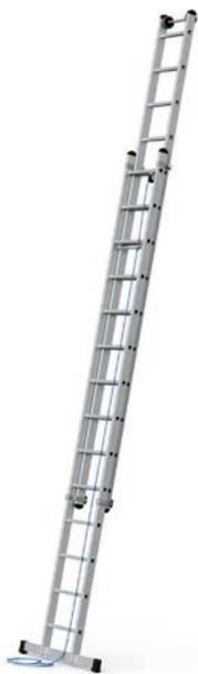
Die einfache und komfortable Höhenregulierung in der Vertikalen ist optimal für den Einsatz als Zugang zu großen Höhen. Besonders einfache und bequeme Höhenverstellung von Sprosse zu Sprosse im Raster von 280 mm durch Kunststoffseil und Rolle. Sichere Arretierung durch automatisch wirkende Einfallhaken. Oberleiter mit Laufrollen ausgestattet. Laufrollen mit abriebfester, wandschonender Lauffläche.
