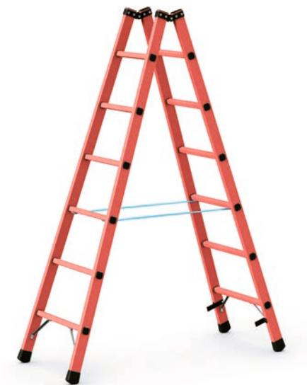
Für den flexiblen Einsatz in elektrischem oder chemischem Umfeld sowie für Arbeiten unter Spannung. Holme und Sprossen aus glasfaserverstärktem Kunststoff für besonders hohe chemische Beständigkeit. Erfüllt die Hochspannungsprüfung für Leitern aus isolierendem Material nach EN 61478 bzw. VDE 0682 Abschnitt 6.5 Kategorie 1/30 KV. Alterungsbeständigkeit nach EN ISO 4892-2. Geeignet für Arbeiten unter Spannung (1.000 V AC, 1.500 V DC).
