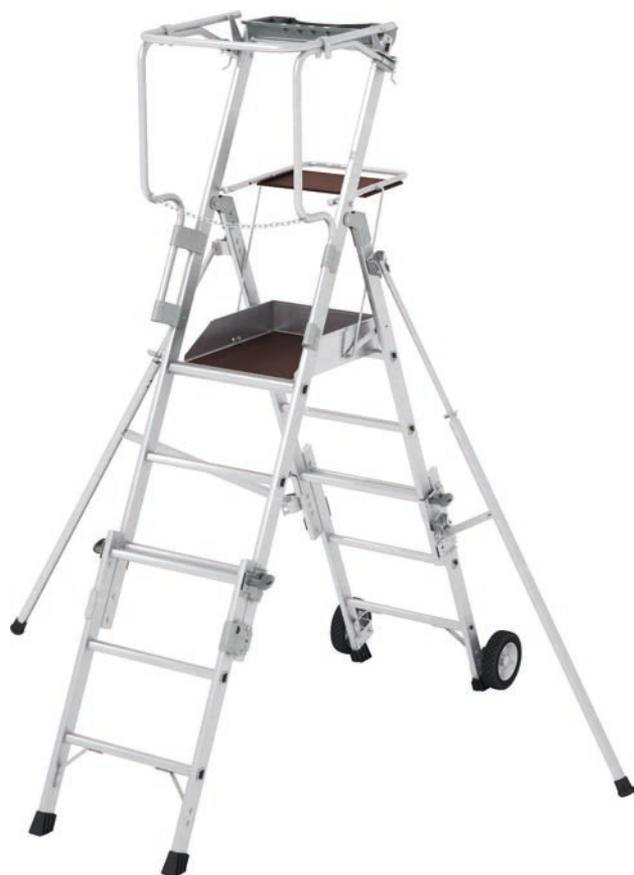
Teleskopierbare Plattformleiter mit praktischen Ablageflächen. Höhenverstellbar durch beidseitig angebrachte, ergonomische Griffe. Platzsparender Transport durch zusammenklappbare Handläufe und hochschwenkbares Schutzgeländer. Zusätzliche Abstellfläche auf Kniehöhe für Gewichte bis 25 kg.
